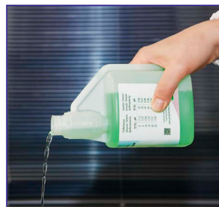
Svuotare il comparto di taratura
