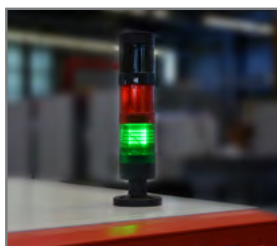
Indicazione dello decorso del programma tramite spia di segnalazione
