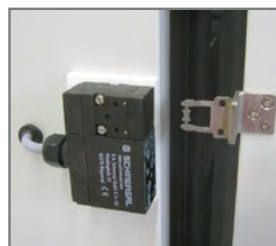
Dispositivo di chiusura elettromeccanico comandato via programma e/o manualmente
