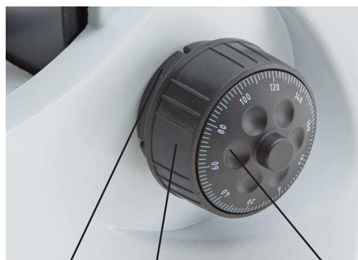
MANDO DE AJUSTE DE TENSIÓN (3) MANDO DE ENFOQUE MACROMETRICO MANDO DE ENFOQUE MICROMÉTRICO
