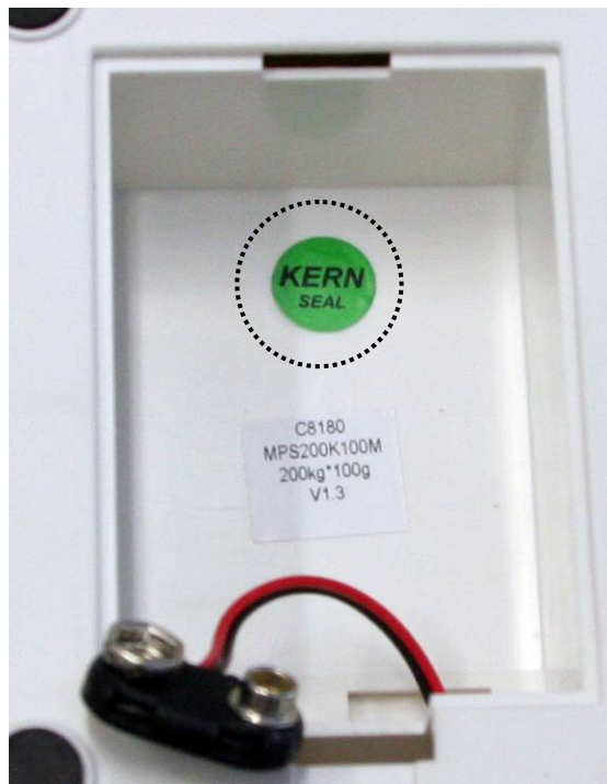
2. Vano delle batterie
