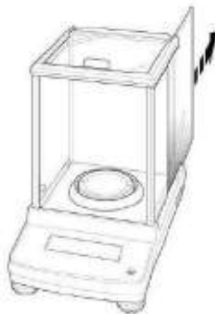
Fig. 2: Rimozione del portello in vetro
