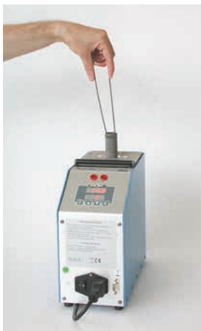
Riscaldamento di una sonda inserita in un calibratore a secco di tipo convenzionale.
