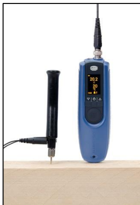
Figura 5-1: Misurazione trasversale rispetto alla direzione delle fibre con M 20
