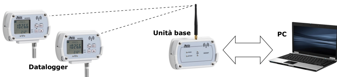
Fig. 2.1: unità base interposta tra i datalogger e il PC
