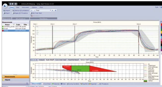
Il temp-gard raccoglie i dati di temperatura nel forno di produzione.
